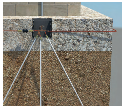
Fig. 13 – Secção transversal de uma ligação à terra.
