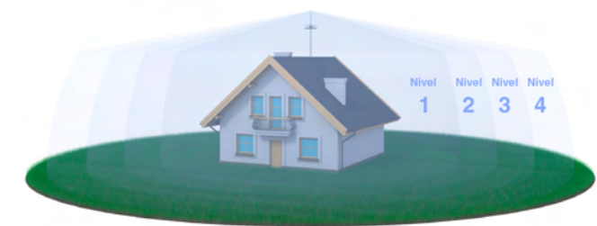
Fig. 4 – Volume protegido com para-raios PDI.
